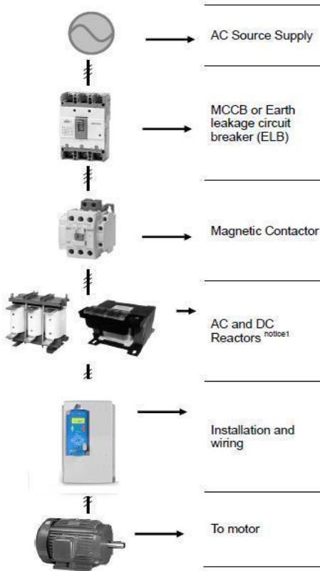
**!** به هیچ عنوان از قطع و وصل برق ورودی "اینورتر" به منظور راه اندازی و توقف الکتروموتور مربوطه استفاده ننمایید. قطع و وصل مکرر ورودی "اینورتر" باعث بروز آسیب اساسی در دستگاه "اینورتر" خواهد شد.
