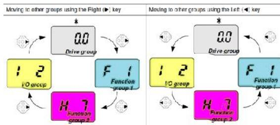
برای جابجایی بین پارامترهای هرگروه از دکمه‌های UP و DOWN واقع بر روی پنل استفاده نمایید.
