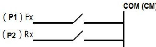
۶- حرکت توسط ورودی های RX یا FX و کنترل سرعت توسط جریان آنالوگ ورودی ۴ تا ۲۰ میلی آمپر
