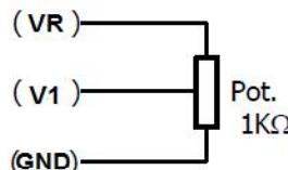
۵- حرکت توسط ورودی های RX یا FX و کنترل سرعت توسط ولوم خارجی و یا ورودی ۰ تا ۱۰ ولت آنالوگ
